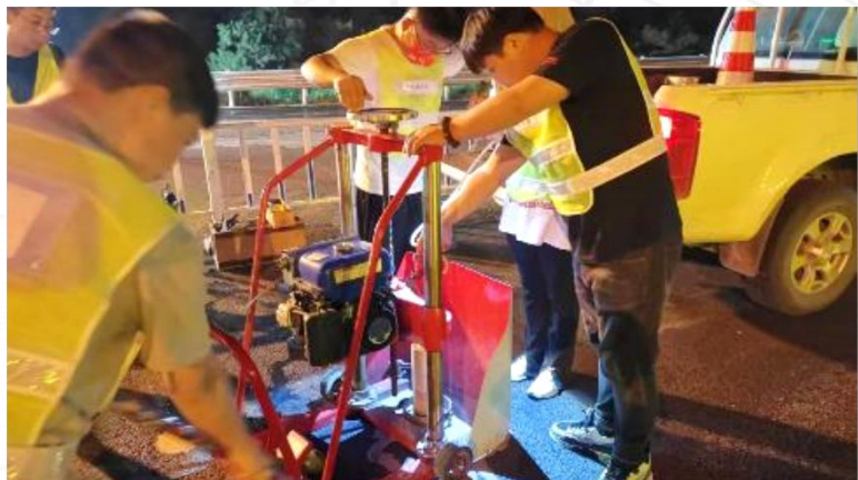
2022年郑州分公司路面修复养护工程施工XZLM-2 沥青路面芯样钻取自检
